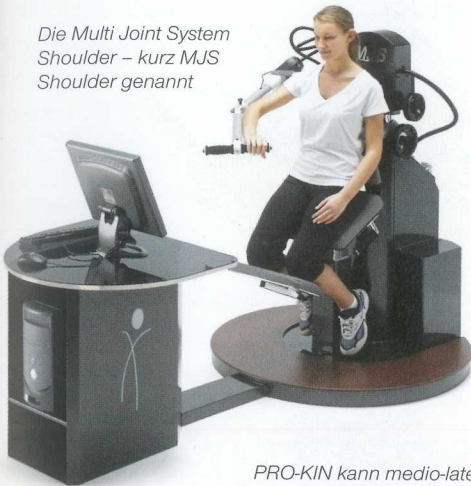
PRO-KIN kann medio-laterale und anteriorposteriore Neigungen von +/-15° mit einer Genauigkeit von 0,1° erfassen
